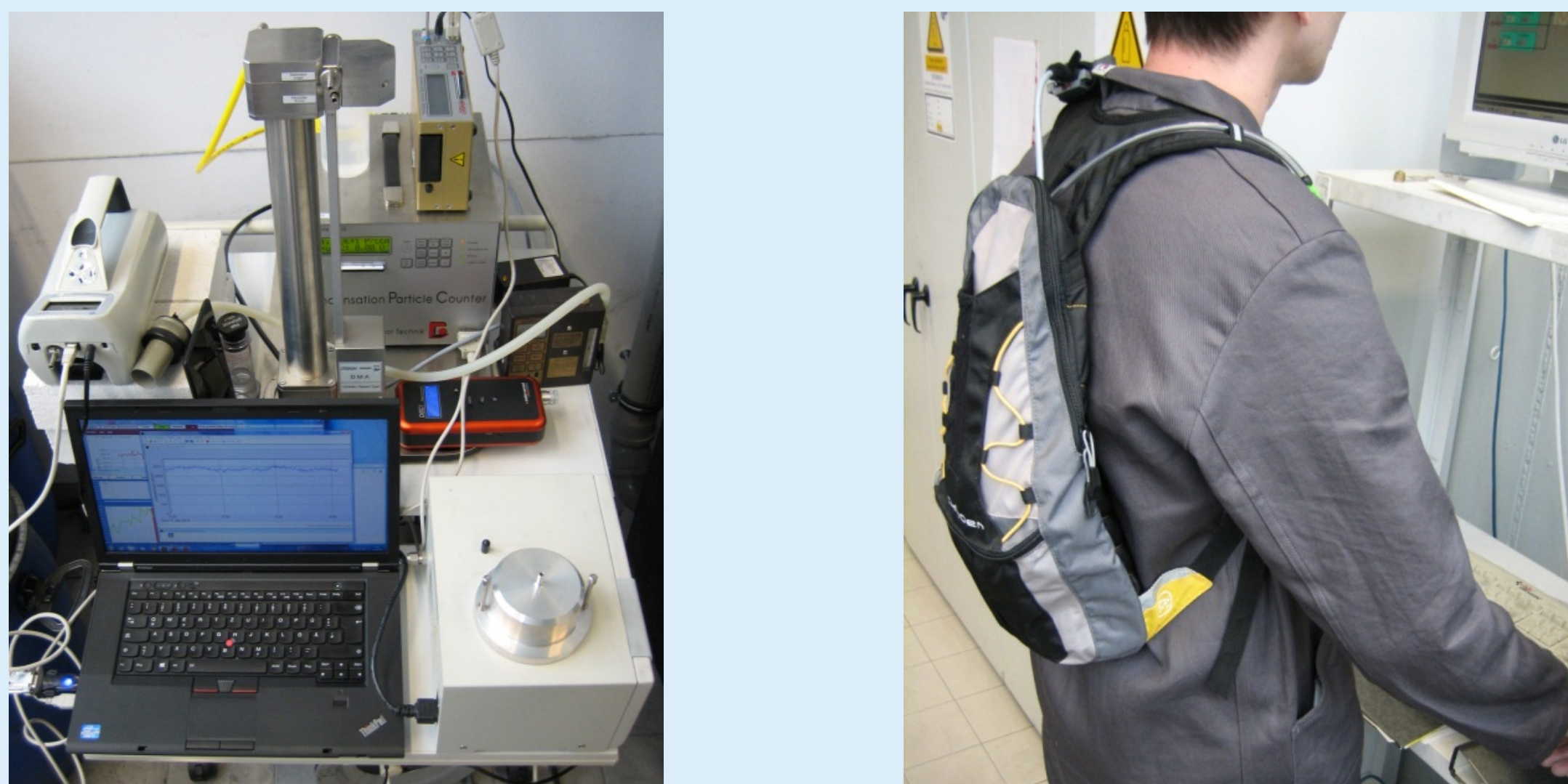
Abb. 1: links stationäre Sammelsysteme (z.B. SMSP, CPC, NAS, OPC), rechts ein mobiles Sammelsystem (z.B. DiSCmini und PGP-FAP)
